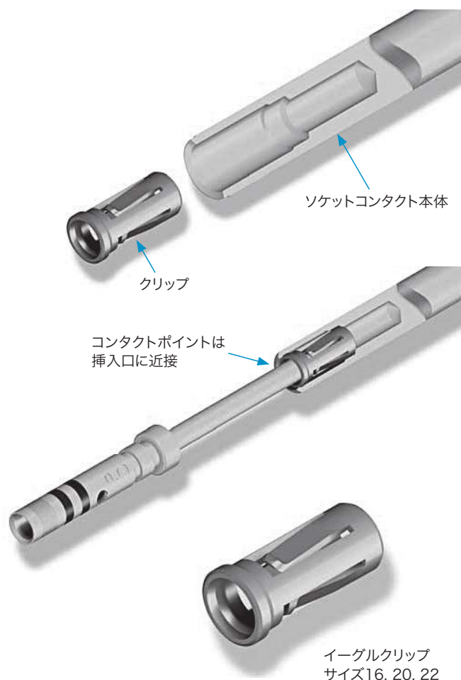
ソケットコンタクト断面図
