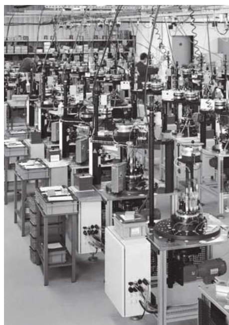
PRECI-DIP工場のスプリングピン製造ライン
