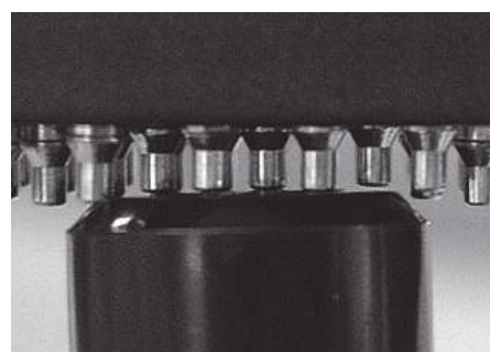
フローティングコンタクト拡大写真
